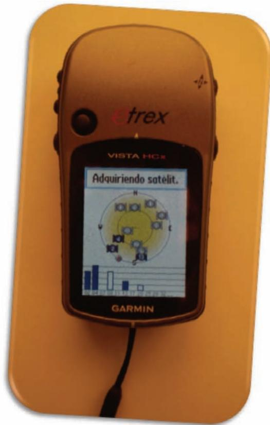
**Figura 5.** Receptor GPS Garmin eTrex Vista HCX. Fuente: Cenipalma, Agricultura de Precisión. 2009.
