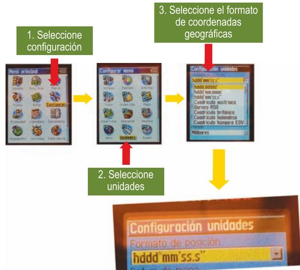
**Figura 7.** Procedimiento para configurar el sistema de coordenadas en el GPS Garmin HCx.
