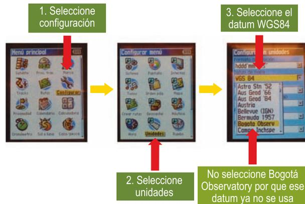
**Figura 8.** Procedimiento para configurar el datum en el GPS Garmin HCx.
