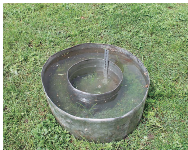
Figura 25. Inicio de la prueba de infiltración
