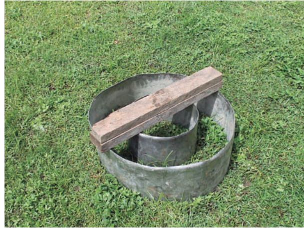
Figura 21. Anillos interior y exterior instalados
