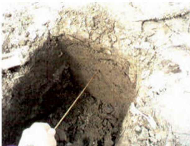
Figura 13. Determinación cualitativa de la resistencia a la penetración.
