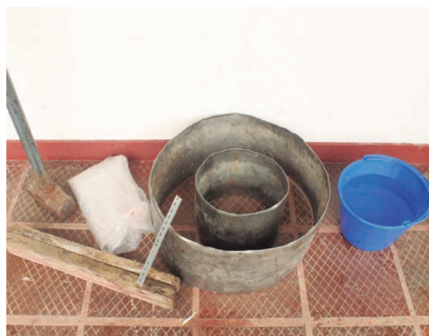
Figura 19. Recursos necesarios para una prueba de infiltración
