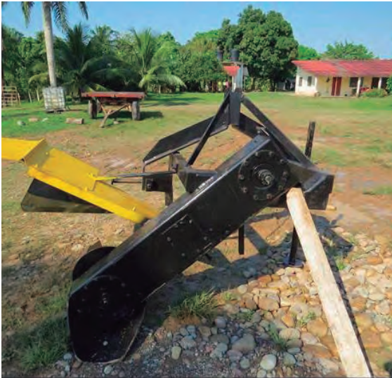
Ditcher – zanjeador mecánico. Foto: Ruth Salazar.
