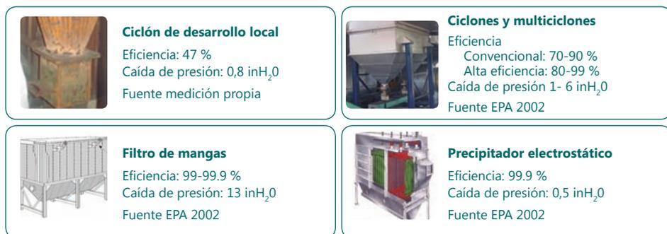
Figura 17. Eficiencia de remoción de MP de los principales equipos de control de emisiones.
