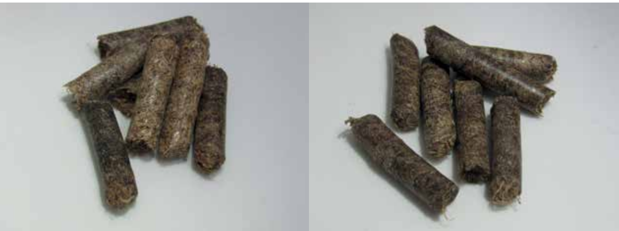
Figura 10. Pellets de tusa (Izq.) y fibra (Der.) de palma de aceite
