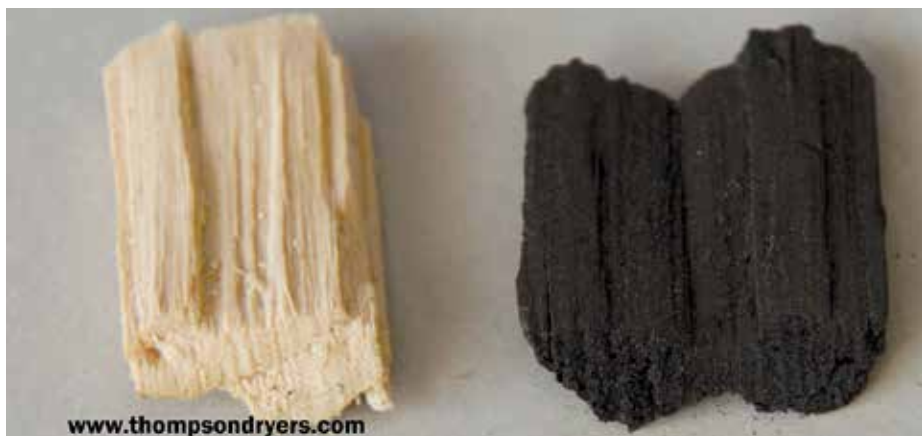
Figura 12. Ejemplo de biomasa en su estado natural Vs. biomasa torrefacto. Fuente: Thompson Dryers
