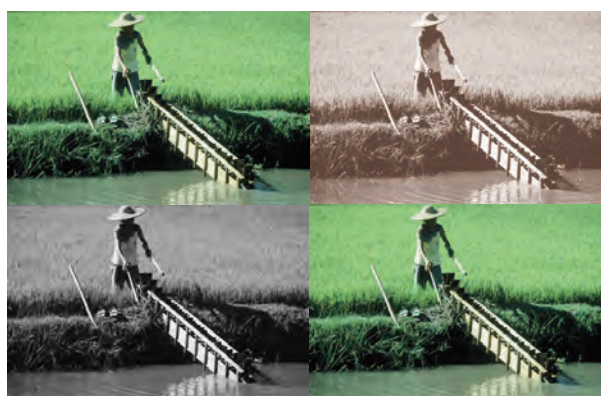
Figura 41. Bomba de pedal para captar agua de fuentes cercanas, utilizada en Vietnam.
