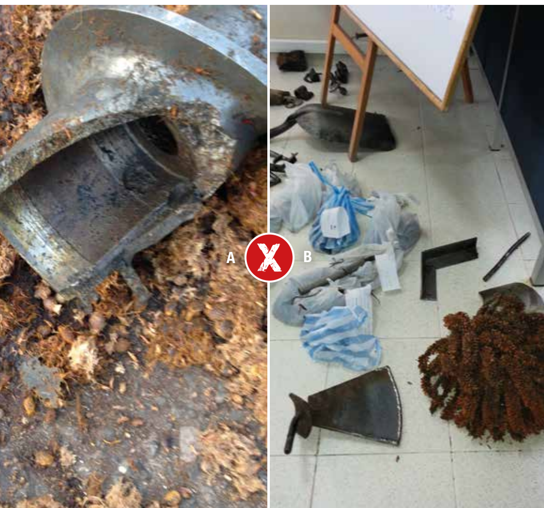
■ A. Daño de tornillo sinfín. B. Impurezas o materiales extraños que afectan el proceso de beneficio del fruto. Fotos: Guerrero, A., y Díaz, C.
