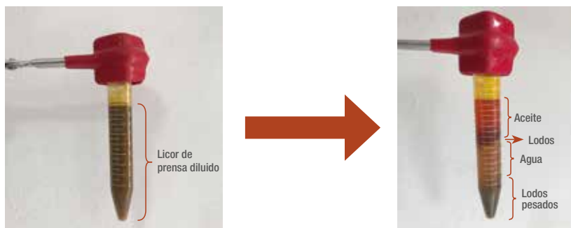
■ Montaje del factor de dilución a escala de laboratorio. Fotos: Fedepalma
