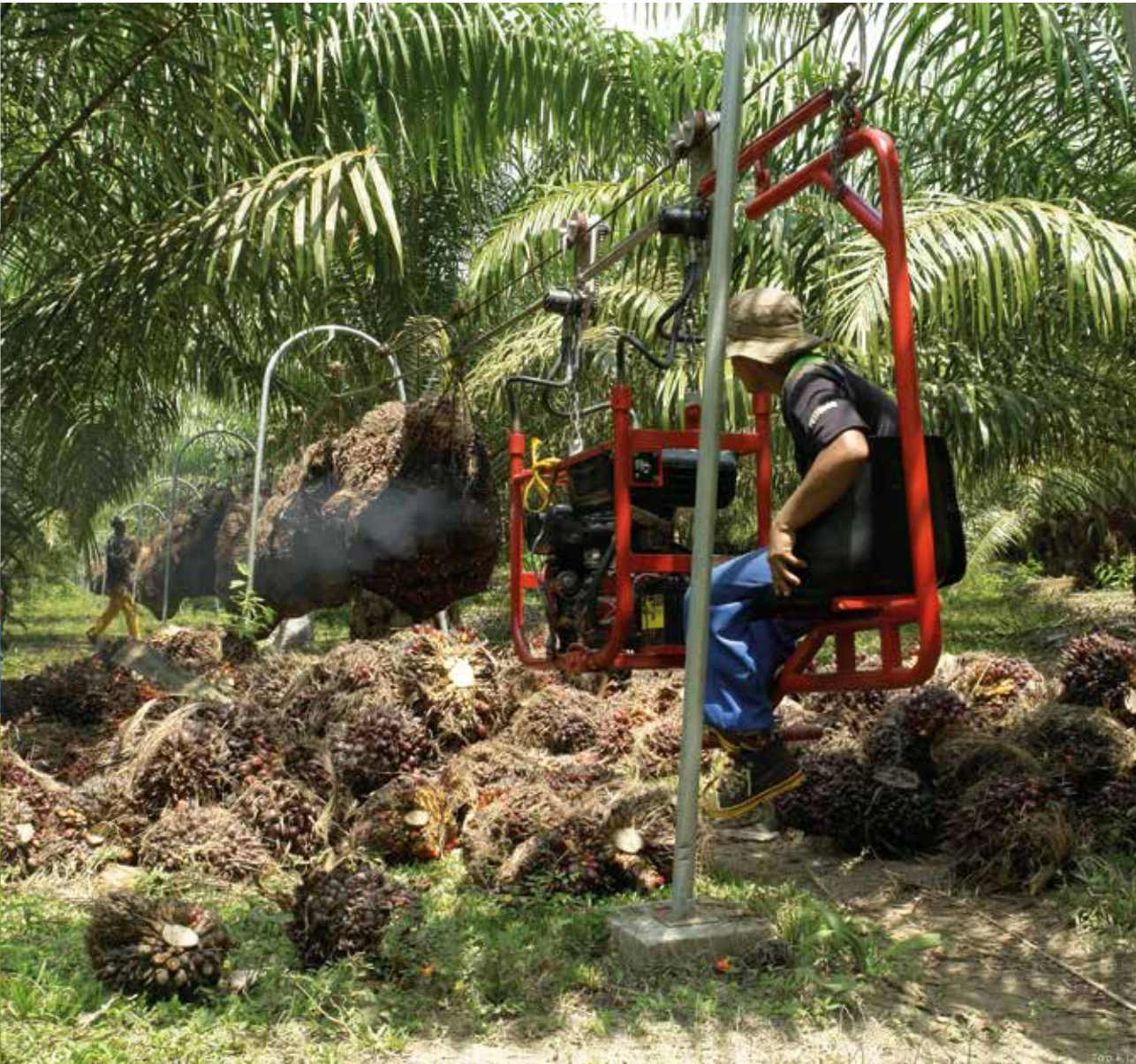
■ Transporte de racimos por cablevía. Foto: Fedepalma
