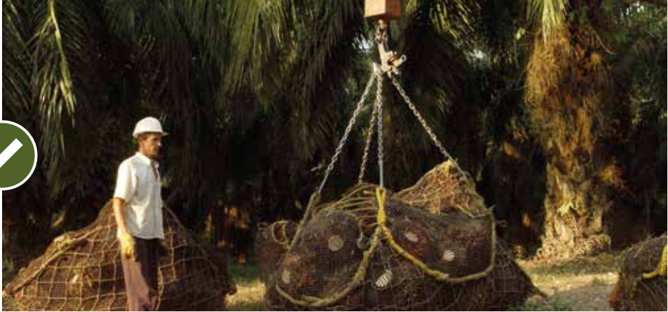
Alce de racimos con mallas y brazo hidráulico. Foto: Fedepalma.
