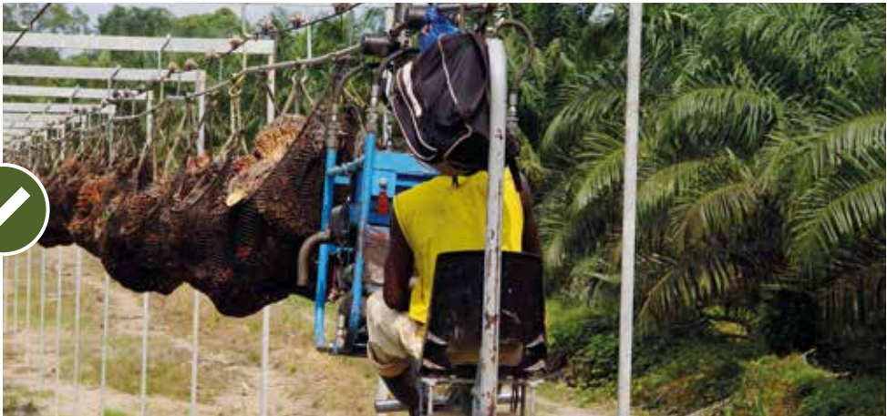
Alce y transporte de racimos con cablevía. Foto: Fedepalma.
