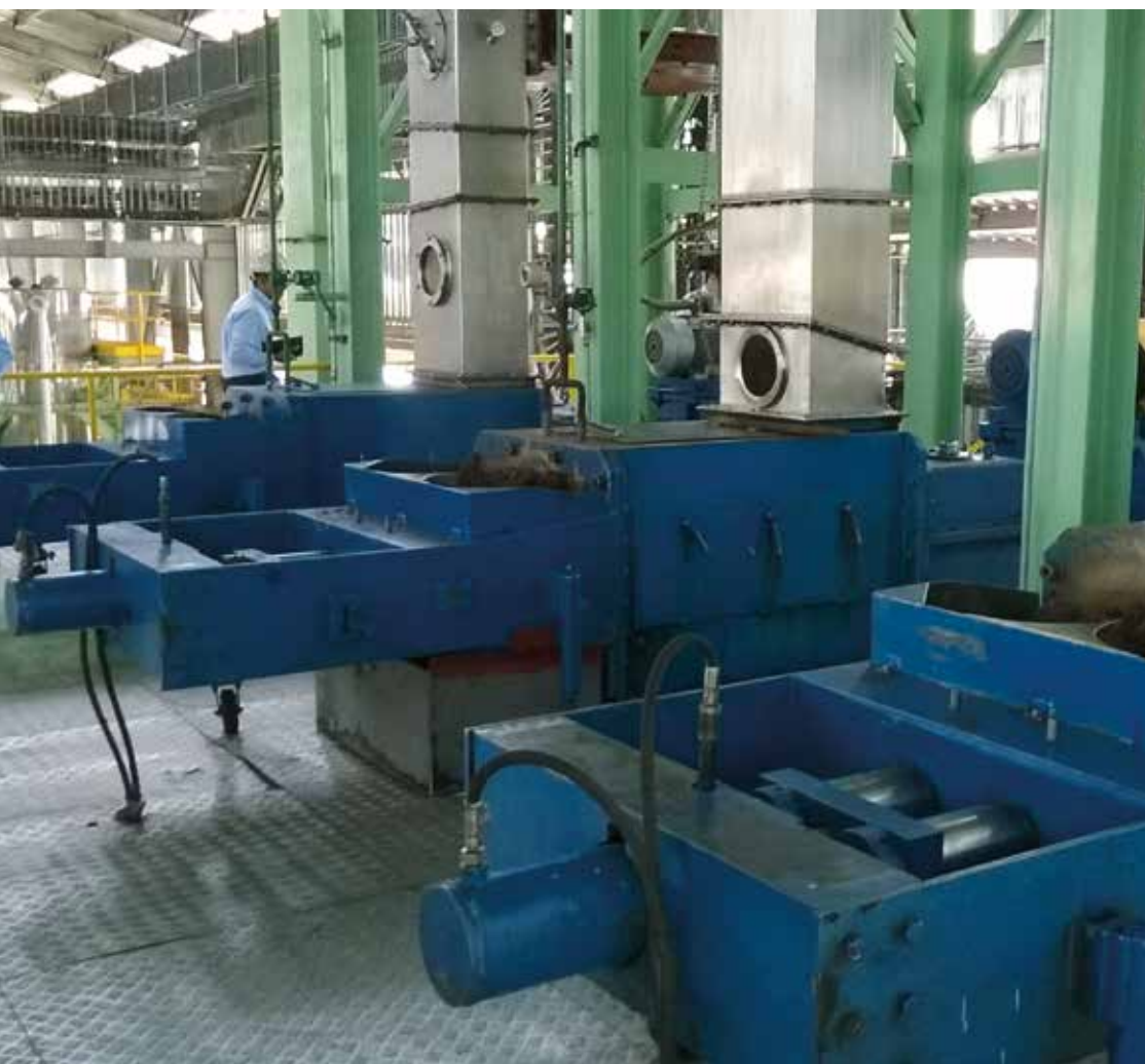
■ Prensa industrial utilizada en el proceso de extracción. Foto: García, J.
