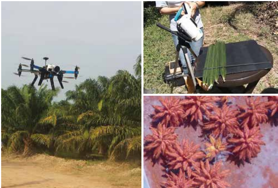
■ Vehículo aéreo no tripulado con sensor multispectral. Fotos: Molina, A., Zabala, A., y Rincón, V.
