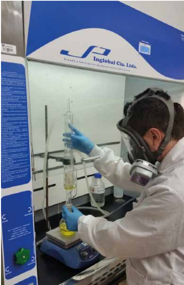
■ Análisis de calidad de aceite por el método Soxhlet. Foto: Munar, D.
