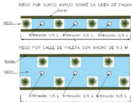
Figura 34. Puntos sugeridos para la determinación de la infiltración en el surco a evaluar. Fuente: Jurado, J.
