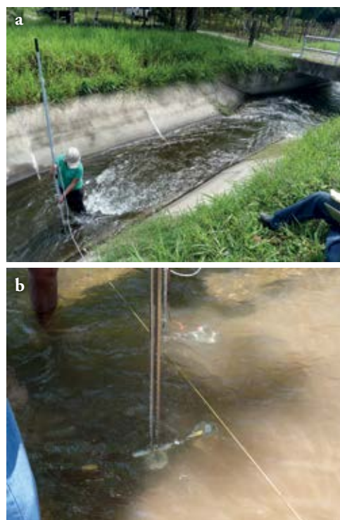
Figura 28. Aforo de canales abiertos con correntómetro (a) Molinete (b). Fuente: https://cedsa-panama.com/equipos-de-cedsa/
