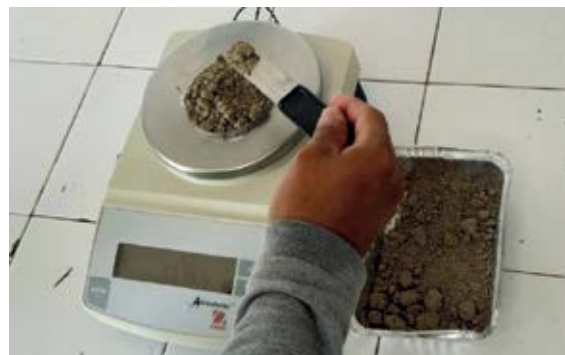
Figura 3. Instrumento de medida de la masa: gramera.
