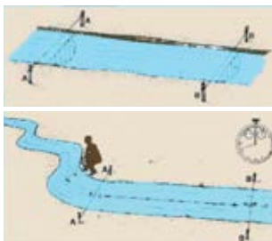
Figura 30. Representación gráfica del procedimiento efectuado en campo para la determinación de caudal por el método de flotador. Fuente: FAO (1998)
